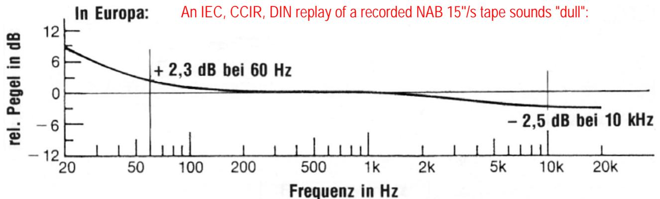
Der Wiedergabefrequenzgang eines NAB-Bandes, das mit der IEC-Norm wiedergegeben wird, klingt zu dumpf, weil Höhen fehlen und außerdem zu viel Tiefen wiedergegeben werden (Korrekturwerte).
