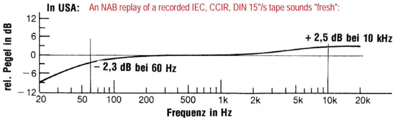
Der Wiedergabefrequenzgang eines IEC-Bandes, das mit der NAB-Norm wiedergegeben wird, klingt zu hell, weil zu viel Höhen wiedergegeben werden und außerdem Tiefen fehlen (Korrekturwerte).
