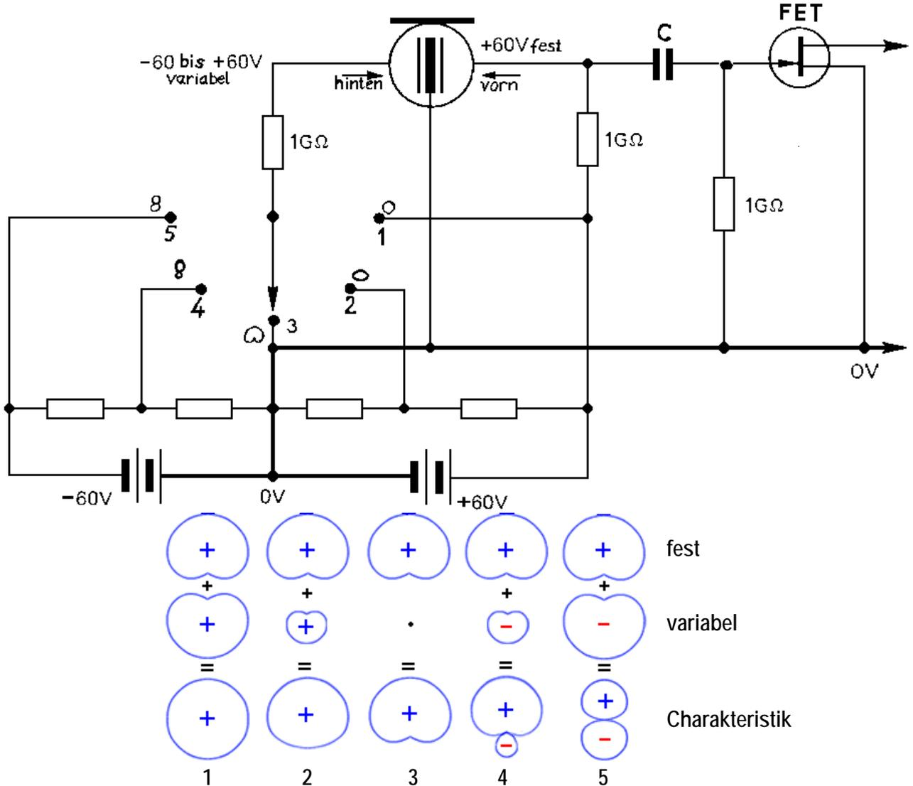
Die Abbildung zeigt, wie beim Doppelmembranmikrofon zwei Nierenkapseln Rücken an Rücken elektrisch kombiniert werden.
