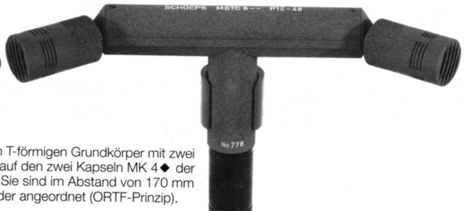
Dieses Mikrofon besteht aus einem T-förmigen Grundkörper mit zwei eingebauten Mikrofonverstärkern, auf den zwei Kapseln MK 4♦ der Colette-Serie geschraubt werden. Sie sind im Abstand von 170 mm in einem Winkel von  $110^\circ$  zueinander angeordnet (ORTF-Prinzip).
