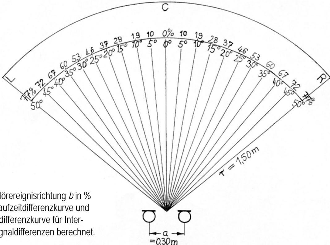
Gesamt-Hörereignisrichtung  $b$  in % aus der Laufzeitdifferenzkurve und der Pegeldifferenzkurve für Interchannelsignaldifferenzen berechnet.
