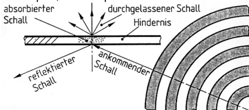
Meistens wird aber die Schallausbreitung durch Hindernisse gestört. Der am Hindernis ankommende Schall wird unterschiedlich reflektiert, absorbiert oder durchgelassen. In der Abbildung ist nicht zu erkennen, dass ein Teil der ankommenden Energie "verlorengeht". Dieses wird mit Schalldissipation bezeichnet.
