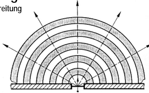
Durch eine schwingende Membran, die in eine starre Wand eingebaut ist, werden Schallwellen erzeugt, die kugelförmig in einen Halbraum abgestrahlt werden. Damit sich die Wellen gleichmäßig ausbreiten können, dürfen sich keine Hindernisse im Schallfeld befinden.
