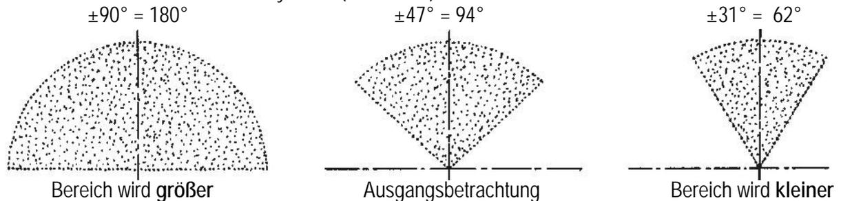
Einstellung der Mikrofonsbasis (A/B, Kugel/Kugel):
