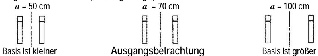
Versuchen Sie sich klarzumachen, weshalb ein Verkleinern der Mikrofonsbasis  $a$  zum Vergrößern des Aufnahmebereichs des Mikrofonsystems führt und dieses wiederum in Abhängigkeit vom Ausdehnungsbereich des Klangkörpers eine Verkleinerung der Abbildungsbreite auf der Lautsprecherbasis ergibt.
