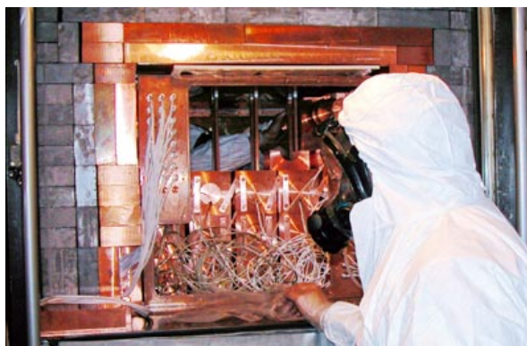
Рис. 21: Установка детекторов внутри куба. [32]
