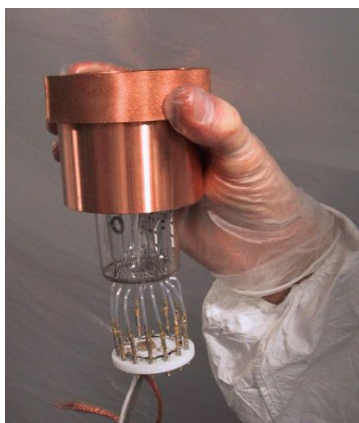
Рис. 20: Внешний вид низкофоновый ФЭУ использующийся в DAMA / LIBRA. [32]
