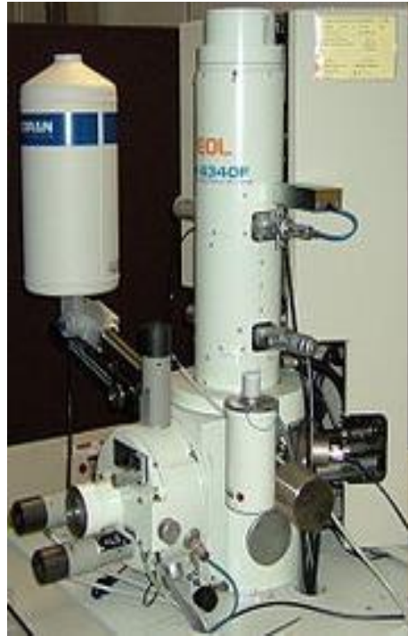
Электронный микроскоп Разрешение до \sim 5 нм
